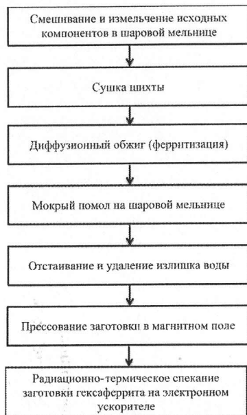
Рис. 1. Технология изготовления гексаферритов методом радиационно-термического спекания
